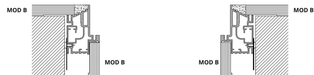
MONTAGE AVEC BATTENTE 50 / PIUMA / RELAX / SENZA TRAVERSO / TRAPEZOIDALE / SYSTÈME ACOUSTIQUE À FIL DE CLOISON 90 et plus POUSSER
