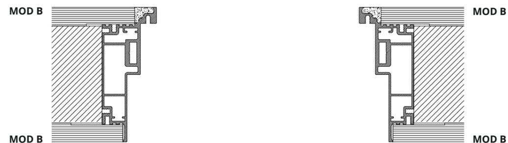
MONTAGE AVEC BATTENTE 50 / PIUMA / RELAX / SENZA TRAVERSO / TRAPEZOIDALE / SYSTÈME ACOUSTIQUE À FIL DE CLOISON 90 et plus TIRER
